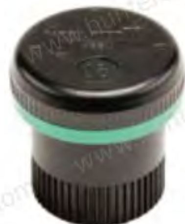
نازل مدل MSBN-50Q-50H دبی ۰.۱۱ متر مکعب در ساعت ۱.۹ لیتر در دقیقه
